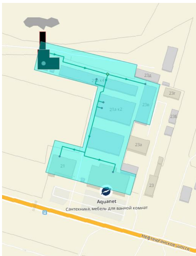
Рисунок 3.49 – Зона действия котельной АО «Горремстрой» ООО «Скат-База»
