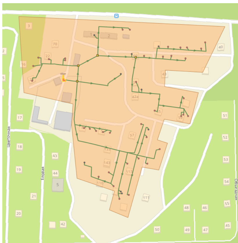
Рисунок 3.16 – Зона действия котельной №25 п. Лесной СГМУП «ГТС»
