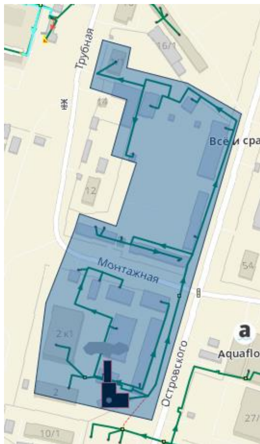
Рисунок 3.32 – Зона действия котельной №8 ПАО «Сургутнефтегаз»
